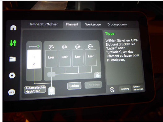
Fig.14: Vor Start: Filamente gänzlich entfernt: Bei Start blinken die LEDs, bereit für neue Filaments einfügen.
